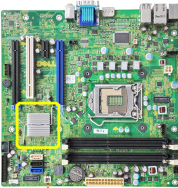
그림 1. 방열판이 장착된 시스템 보드의 이전 버전
